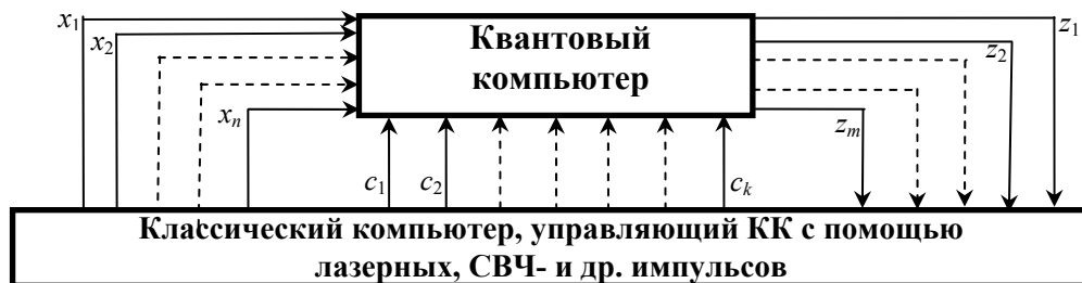
Рис. 1. Схема соединения КК и управляющего им классического компьютера.
