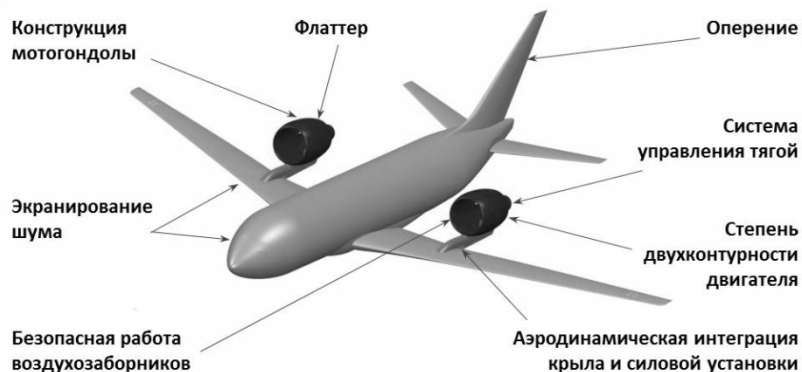
Рис. 4. Ключевые элементы в расчетной концепции самолета.
