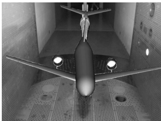
Рис. 5. Валидация технологий. Экспериментальные исследования модели самолета в аэродинамической трубе.
