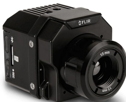
Рис. 3б. Тепловизор с спектральным диапазоном 7,5-13,5мкм.
