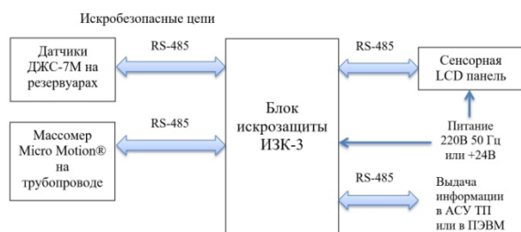
Рис. 1. Структурная схема измерительной системы.
