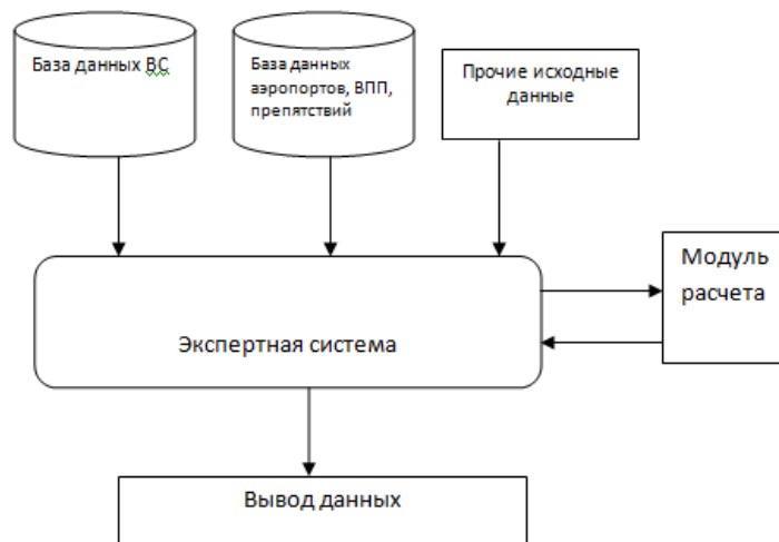
Рис. 1. Архитектура процесса расчета ВПХ.
