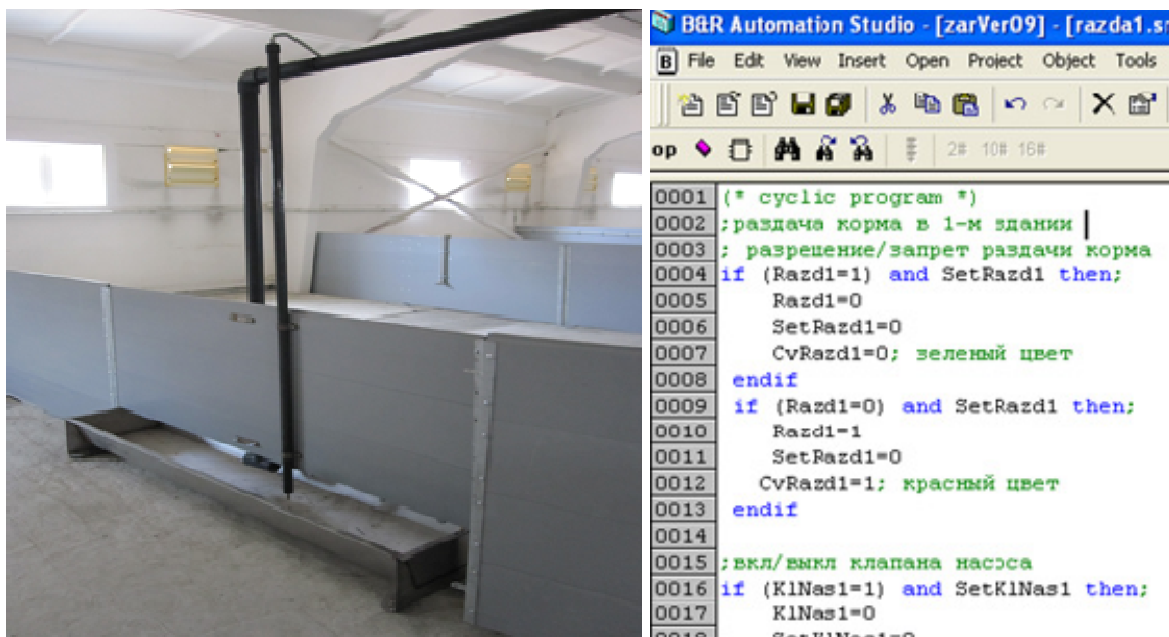
Рис. 3. Общий вид датчика наличия корма в кормушке (а) и фрагмент управляющей технологической программы (б).
