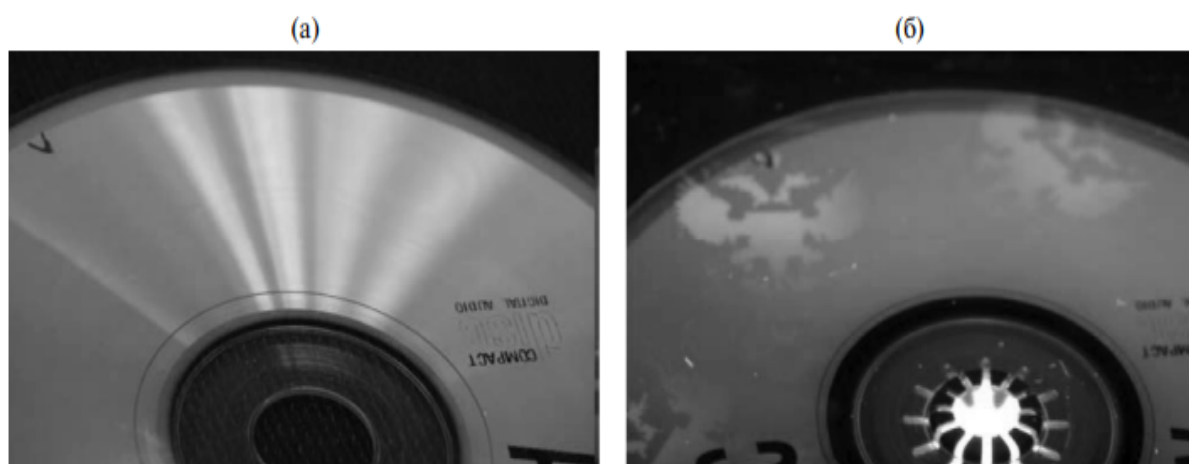
Рис. 1. Фотомодифицированный образец CD-диска: (а) – в видимом свете, (б) – при УФ-освещении некогерентным источником.
