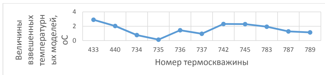
Рис. 3. График с величинами взвешенных температурных моделей термоскважин на выбранном участке трассы магистрального нефтепровода.
