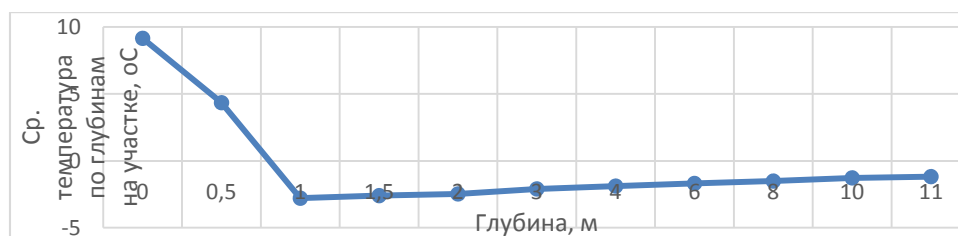
Рис. 2. График усредненных по слоям температур многолетнемерзлом грунте для термоскважин выбранного участка трассы магистрального нефтепровода
