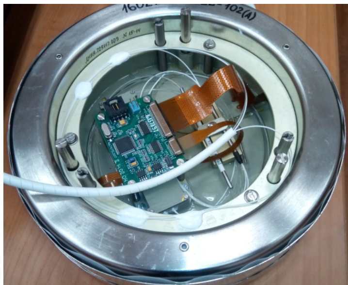
Рис. 2. Фотография оптической части (со снятым верхним магнитным экраном) ВОГ, производства АО «Концерн «ЦНИИ «Электроприбор».
