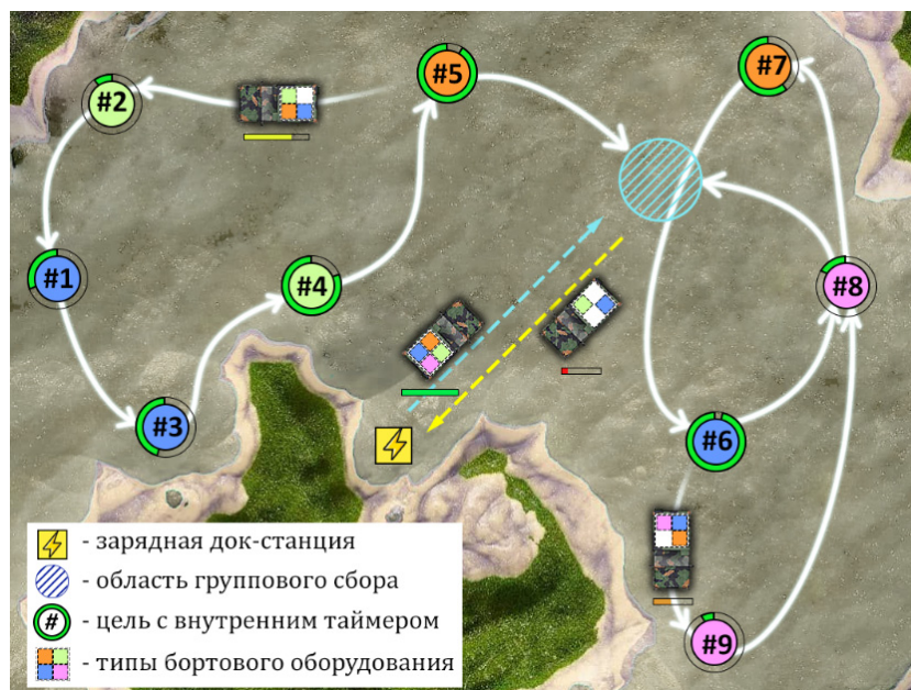
Рис. 1. Схематическое представление выполнения миссии по комплексному мониторингу области гетерогенной группой наземных АМР с непостоянным составом.
