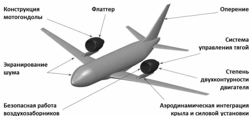
Рис. 4. Ключевые элементы в расчетной концепции самолета.
