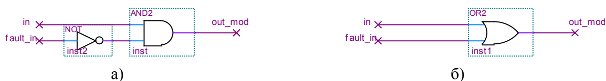
Рис. 1. Модели, имитирующие сбой «залипания». а) – Модель «залипания» в лог. «0», б) – модель «залипания» в лог. «1». Сигнал генерации ошибки fault_in подается лог. «1».
