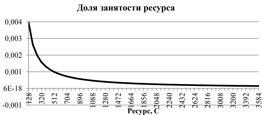
Рис. 4. График зависимости занятости прибора от его объема, при K = 50 .
