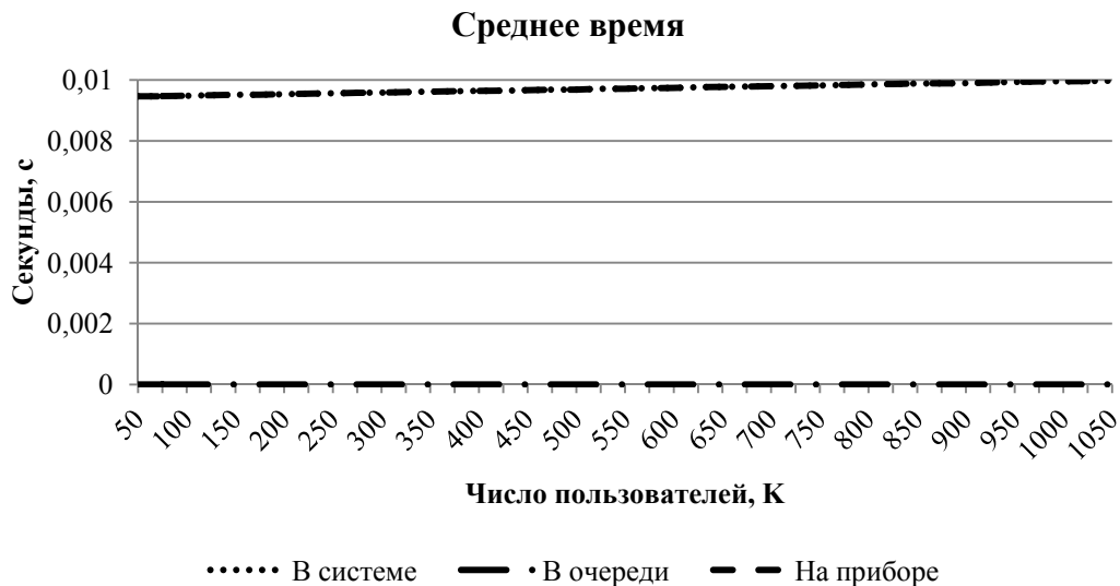
Рис. 2. График зависимости среднего времени пребывания заявки в системе от числа конечных пользователей, при C = 192 .
